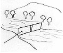
B150 [DAM] Muro o dique que se construye a través de un río, arroyo o canal, para detener el agua y derivarla para su aprovechamiento.
